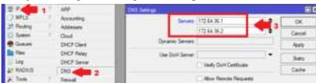
Gambar 8 Konfigurasi DNS pada router Mikrotik
