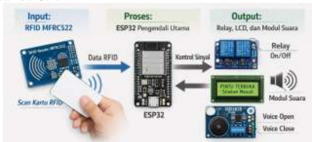
Gambar 1. Arsitektur Sistem otomasi ruang kerja
